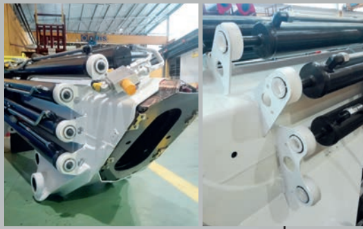
Sistema ritenzione cilindri gru chiusa. Cylinders locking system when crane is folded. Système de retenue vérin à grue fermée. Halterung System mit zusammengelegten Kran.
