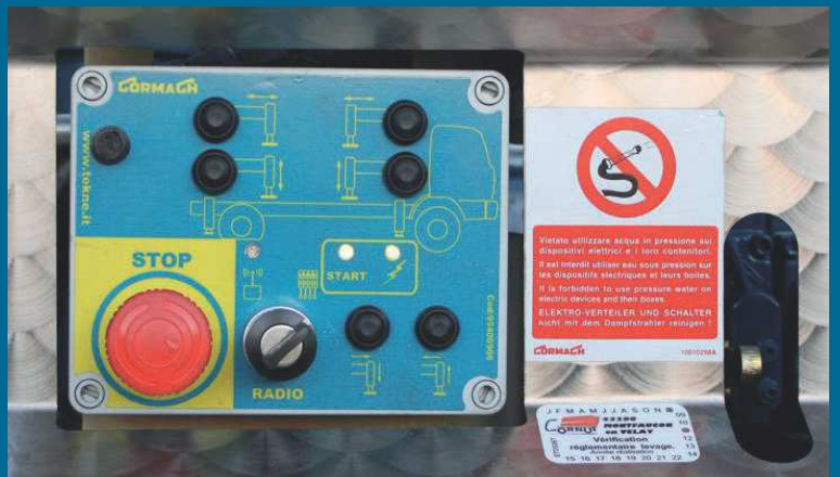
Comandi stabilizzatori elettrici Electric controls of the outriggers Commande stabilisateurs électriques Abstützungen elektronisch gesteuert (oder elektronisch überwacht?) Mandos para estabilizadores electricos
