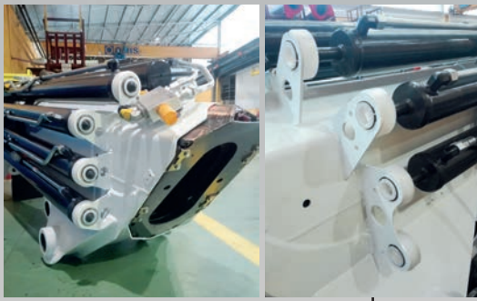
Sistema ritenzione cilindri gru chiusa. Cylinders locking system when crane is folded. Système de retenue vérin à grue fermé. Halteung System mit zusammengelegten Kran.
